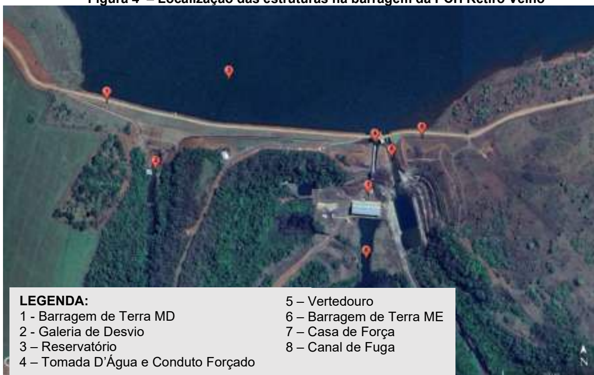
Figura 4 – Localização das estruturas na barragem da PCH Retiro Velho
